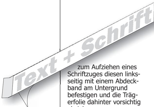
zum Aufziehen eines Schriftzuges diesen linksseitig mit einem Abdeckband am Untergrund befestigen und die Trägerfolie dahinter vorsichtig abziehen.
