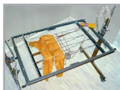
Das Tischgestell ist höhenverstellbar von 600 bis 1'500 mm Höhe, und rundum um 360° drehbar.
